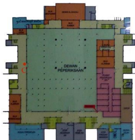
Rajah 1b: Kedudukan data logger di aras bawah (kolong) Masjid Sultan Ismail, UTM Skudai Sumber: Nabeeha et al., (2014)
